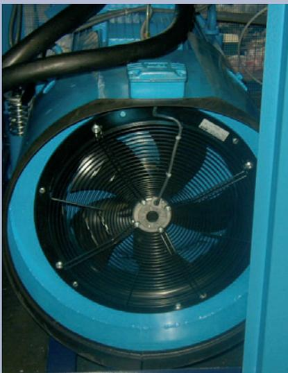
Motor de corriente trifásica, tipo de protección protección IP55, de 4 polos
