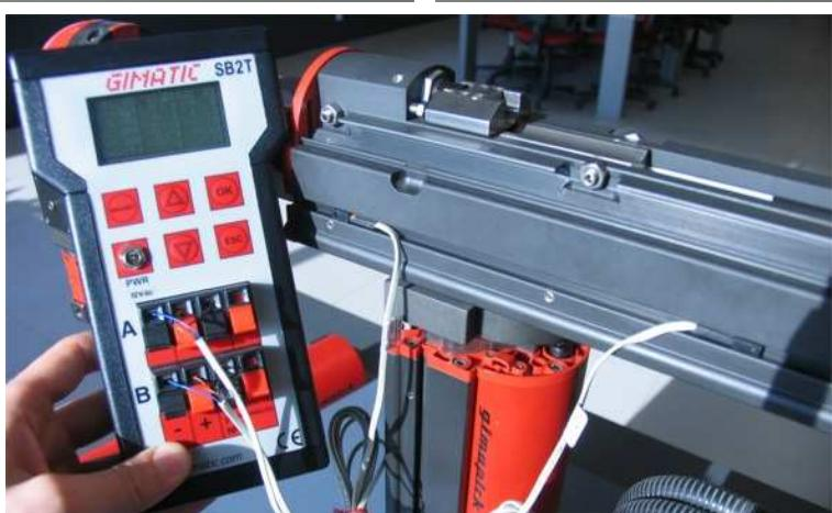
La funzione cronometro permette di misurare il tempo che intercorre tra lo spegnimento del sensore A e l'accensione del sensore B e viceversa. Il tempo è poi calcolato come istantaneo (IST), medio (AVG), massimo (MAX), minimo (MIN) e contacicli (CYCLE). Tramite lo ZOOM è possibile visualizzare a schermo intero ogni singola funzione.
